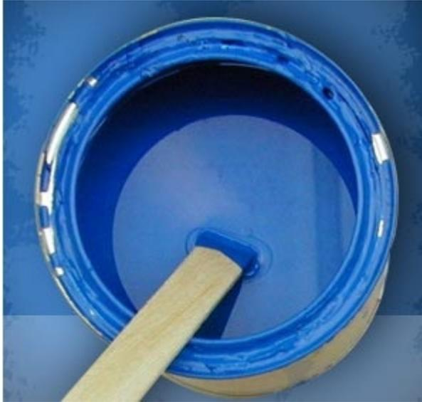
*Toutes les peintures courantes peuvent être appliquées au pistolet à condition d'être préparées. Pour être pulvérisée, la peinture doit être un peu plus liquide que pour être appliquée au pinceau ou au rouleau.*
