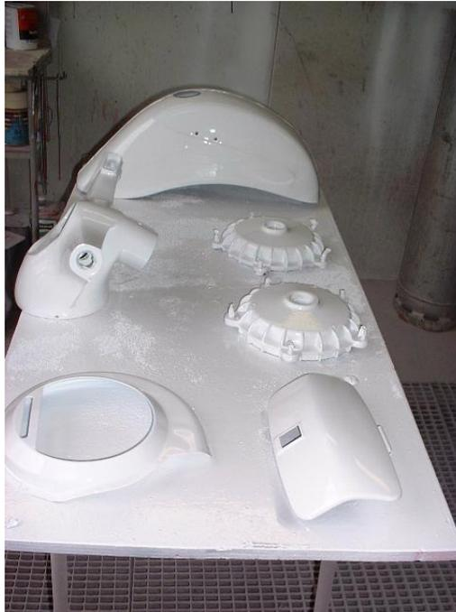
Une fois que vous êtes prêt à peindre (sol mouillé, compresseur chargé, élément soufflé et dégraissé) commencez par régler votre pistolet à peinture (2,5 tours de débit en général, et 2,2 bars de pression au minimum pour un pistolet basse pression)
