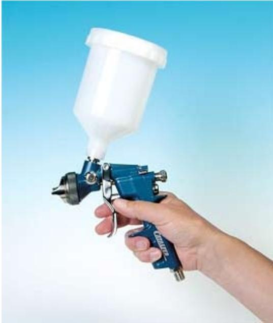
*La pression d'air au pistolet doit être de 2 à 6 bars selon les modèles. Utilisez un manomètre pour régler celle-ci.*
